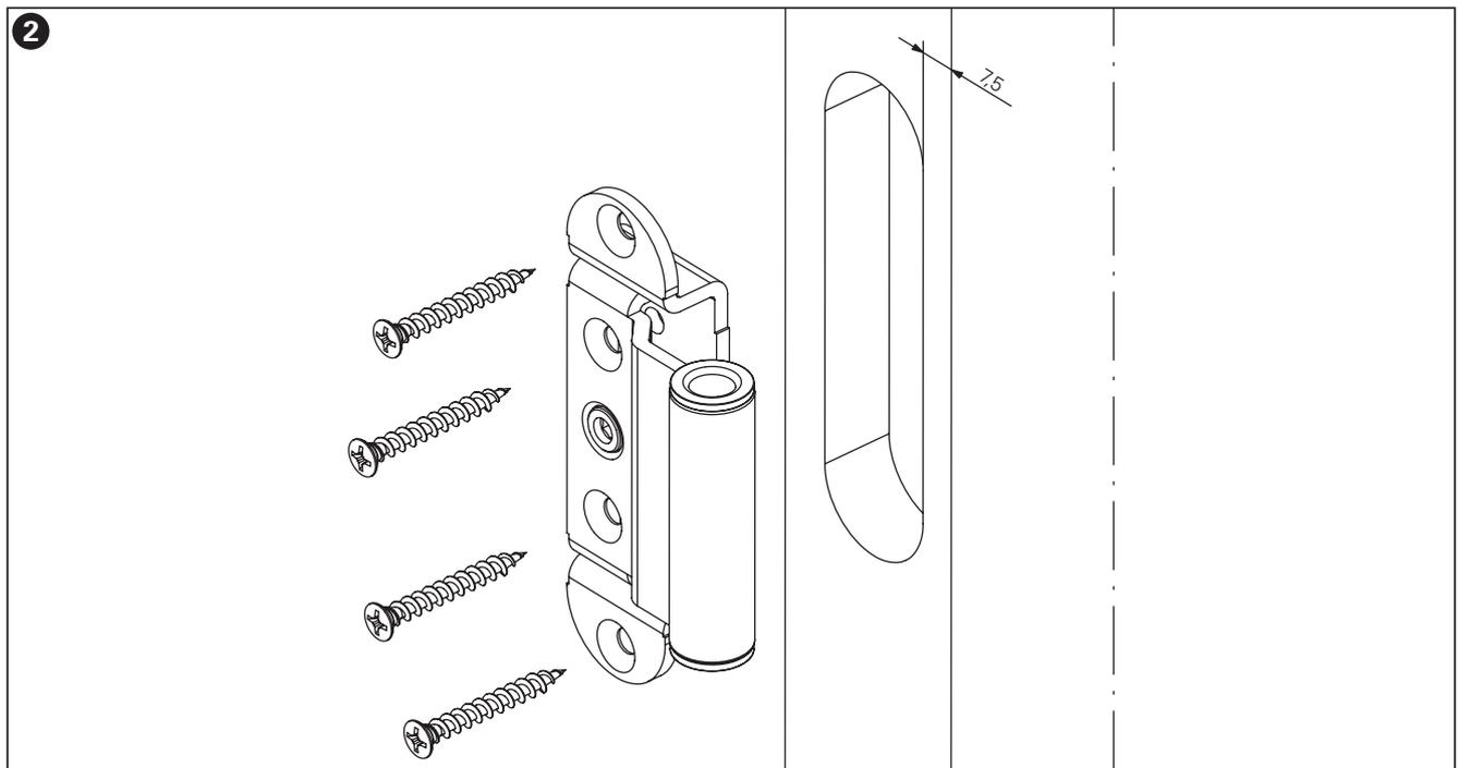
Inserire la parte anta nella fresatura e fissare con viti adeguate al tipo di materiale del serramento.
