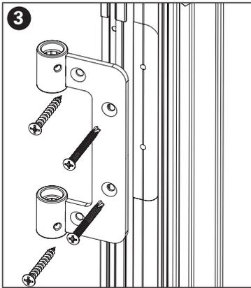
Fissare la parte telaio con viti adeguate al tipo di materiale del serramento.
