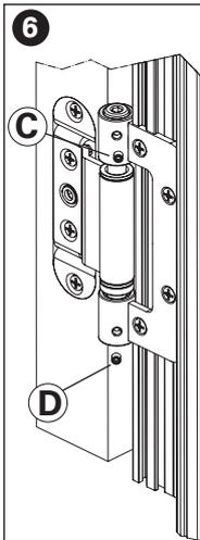
Inserire l'anta nel telaio e inserire la spina (B). Avvitare la spina con brugola da 4mm portando a quota 6mm.
